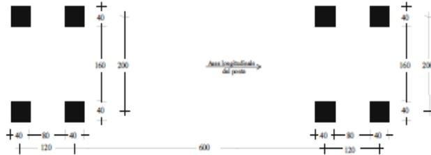
Figura 5.1.5 - Modello di carico a fatica n. 3
